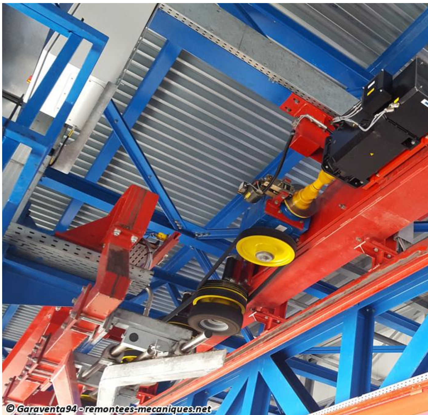
Vue du moteur entraînant la batterie de pneus du ralentisseur
