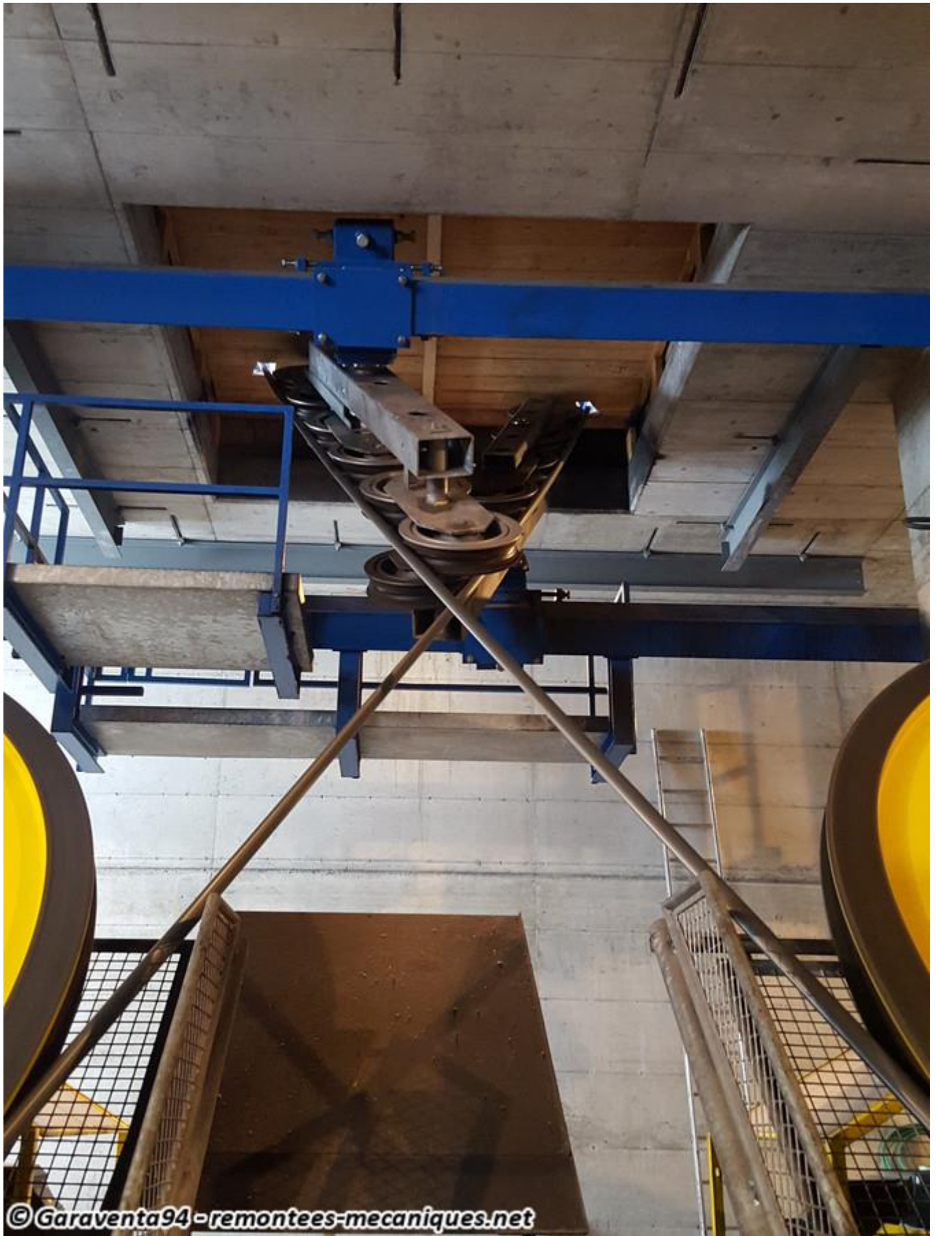
Vue du croisement du câble, effectué par deux trains de galets
