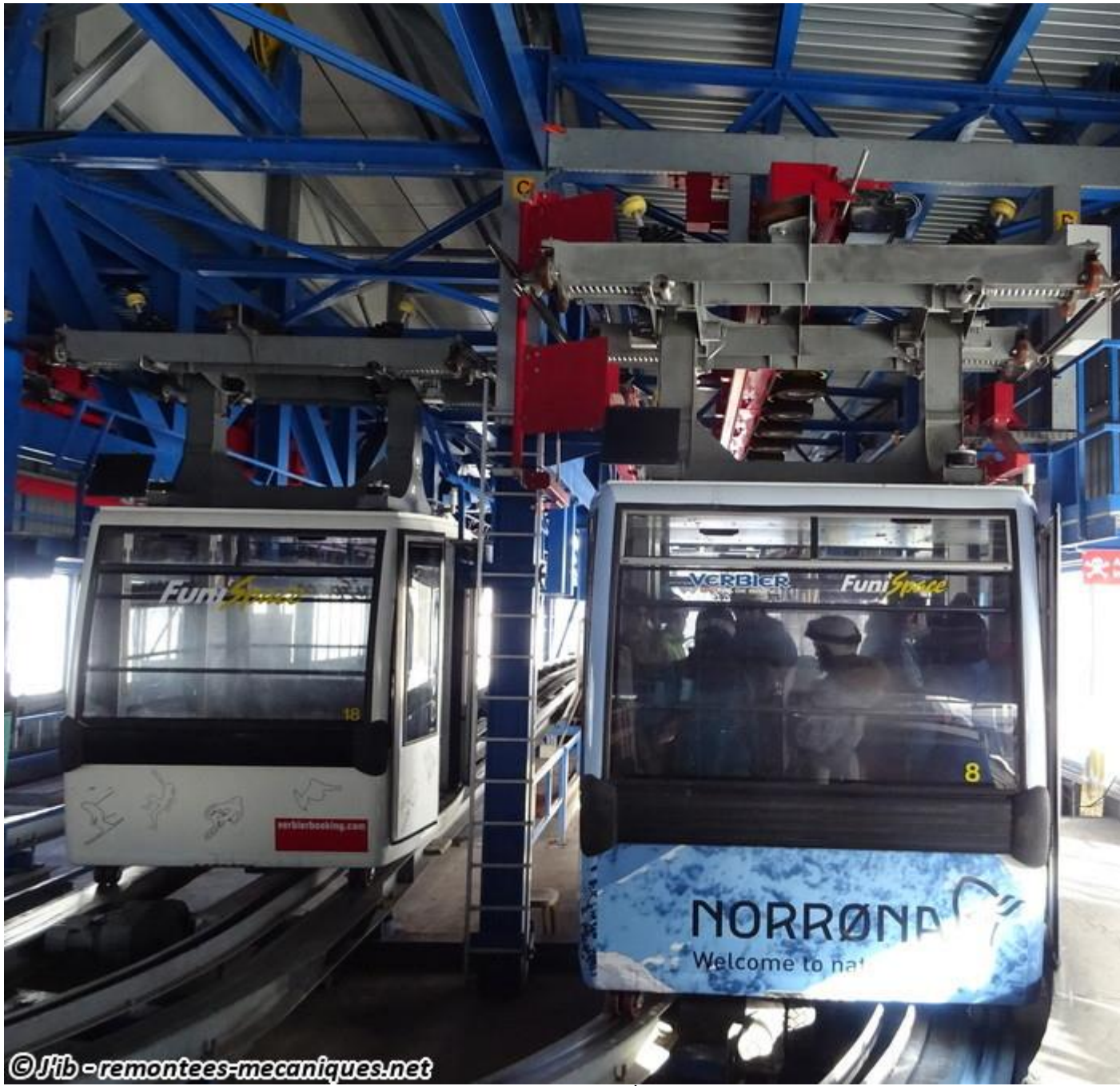
Une cabine s'apprête à quitter le contour et entrer dans le lanceur. À la droite de la photo se trouve le garage des cabines.
