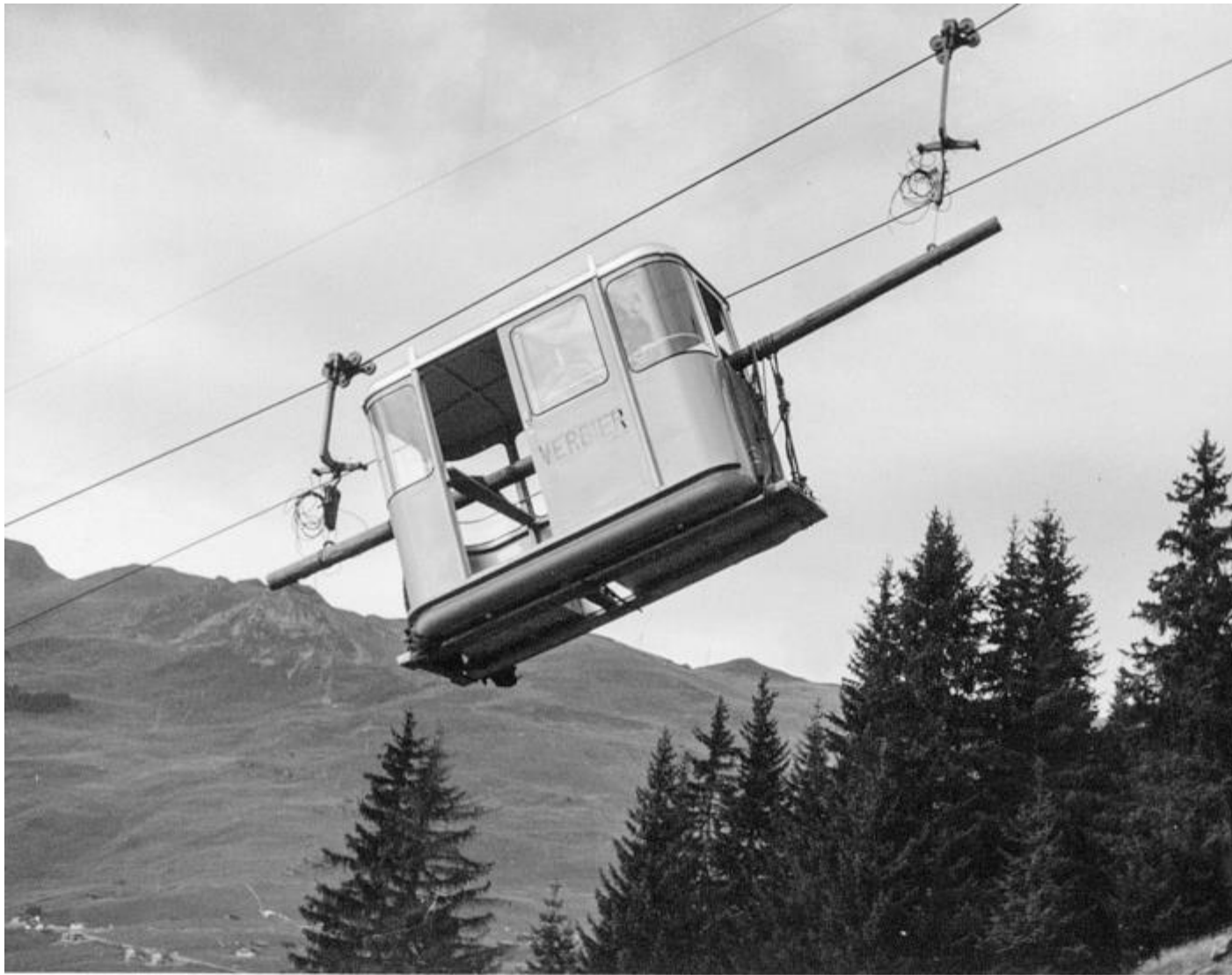
Deux pinces sont nécessaires au bon transport de la benne. Cette dernière est étonnement tenue par l'intermédiaire d'un tronc d'arbre. (Téléverbier)
